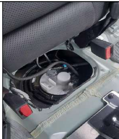
Ilustración 11. Equipo de medición y conexión del equipo a las líneas de combustible.
