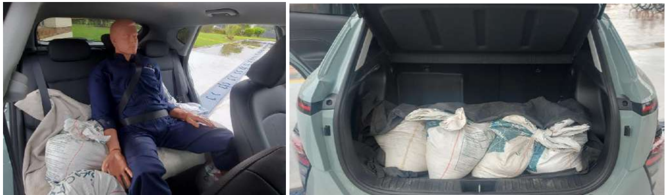
Ilustración 10. Vehículo con carga de 450 kg (incluye conductor y acompañante)
